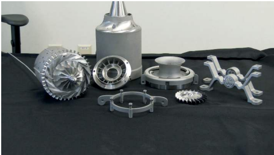
Figura 4: Prototipo de motor operativo de GE impreso en 3D
